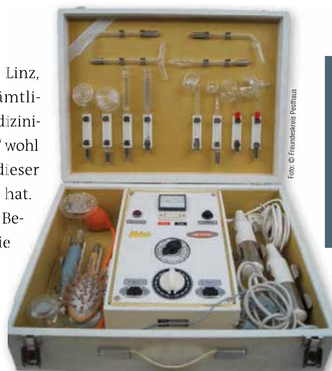
← Abb. 2: Hochfrequenz-Strahlapparat „Helios“ der Firma Franz Gischka in Linz mit 16 Glaselektroden, um 1970, Maße 50x38x14 cm, Inv.Nr. 3183.
